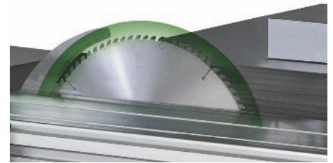
/ Das Sicherheitsumfeld umschließt das Sägeblatt und schützt vor Zugriff aus allen Richtungen.
